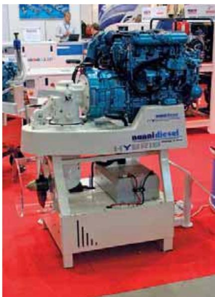
● Новинка от «Nanni Diesel» – гибридный мотор с генератором, аккумулятором и колонкой. Это пока один из немногих опытов постройки «гибридов» для маломерного флота, однако желающие приобрести такой вариант уже есть.
