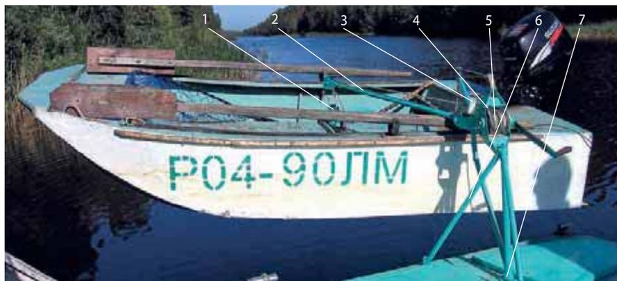
**Рис. 7.** «Подъемник» – поворотный двухконсольный кран для подъема лодки
