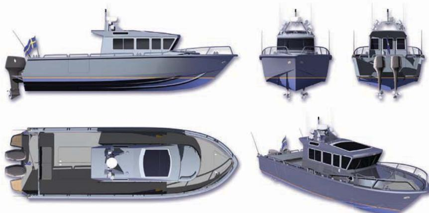
**Рис.3.** Алюминиевый катер «XP1030» в «рабочем» стиле – пример судна, предназначенного для скандинавского рынка, такая «квинтэссенция практичности». Обращает на себя внимание обратный наклон рубки, архитектура walkaround, бортовые и кормовые окна рубки выполнены сдвижными в рамках, лобовое – гнущее цельное из стекла. На крыше рубки предусмотрен санузел внушительных размеров, для чего часть рубки имеет плоскую форму в плане. Бортовая дверь облегчает посадку на судно в марине.
