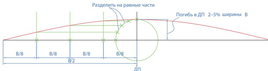
Рис.6. Способ построения погиба бимсов палубы (аналогичный способ используется для построения классической седловатости борта). По Н.Сhapelle «Yacht Designing and Planning» (1932) погиб бимсов рекомендуется принимать равной 40–80 мм на 1 м ширины.
