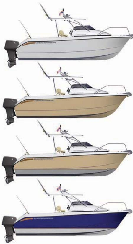
Рис.11. Варианты окраски катамарана AT800. Обратите внимание, насколько темно-синий вариант с отбитой ватерлинией кажется изящнее белого, а ведь это один и тот же корпус!
