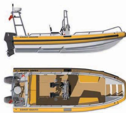
Рис.9. Кат-PIB NSC680 – пример катамарана с надувным бортом (D-труба) и носовой аппарелью.
