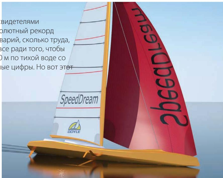
**Основные данные яхты проекта «SpeedDream»:** длина макс. – 30,0 м, по КВЛ – 29,7 м, ширина макс. – 6,0 м, по КВЛ – 3,0 м. Водоизмещение – 18 т, масса балласта – 9 т. Площадь парусности лавировочная (грот+генуя) – 480 м<sup>2</sup>, на попутных курсах – 1100 м<sup>2</sup>.
