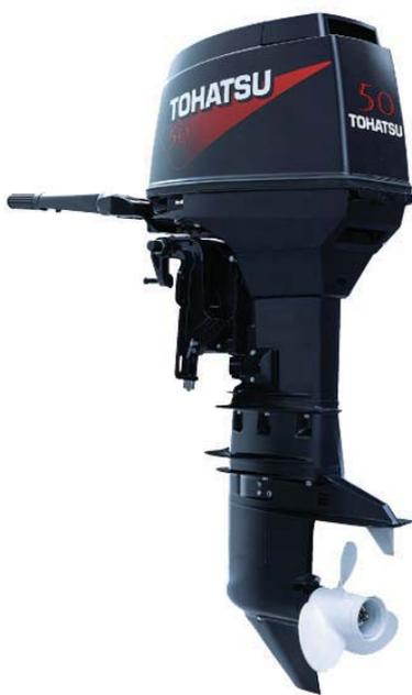
вестный трехцилиндровый подвесник «Tohatsu M50». Основными отличиями «MW50» от своего предка можно считать: наличие водяной помпы большой производительности, хромированной пластины в помпе и увеличенной антикавитационной плиты. Также у «MW50» другое передаточное число редуктора – 1.92 (12/23), у «гражданской» версии – 1.85 (13/24). Со слов одного из конструкторов «Tohatsu», который недавно посетил Россию, редуктор и средняя часть мотора («mid-section», у нас называется
