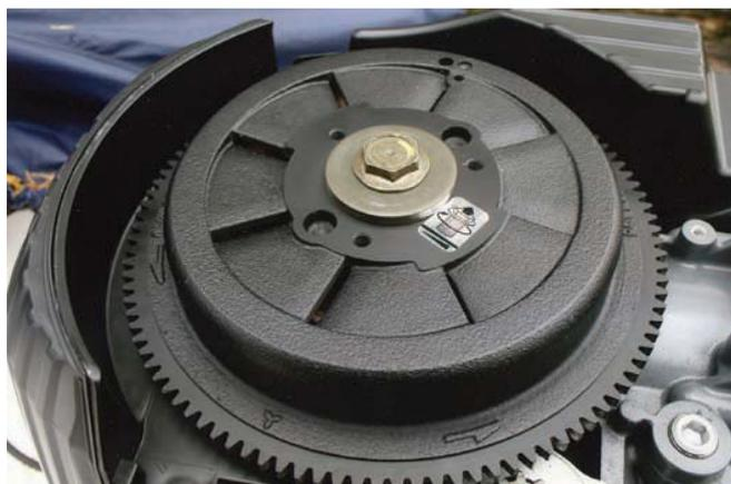
На маховике современных мощных моторов, например «Suzuki-115», может не быть углубления для шнура при ручном запуске. Потребуется специальная лента, с которой нужно заранее потренироваться.
