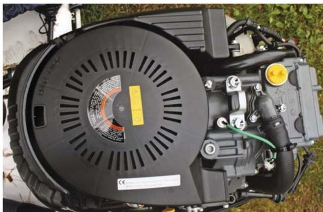
Как правило, маховик мотора закрыт защитным кожухом, снять который на воде бывает сложно
