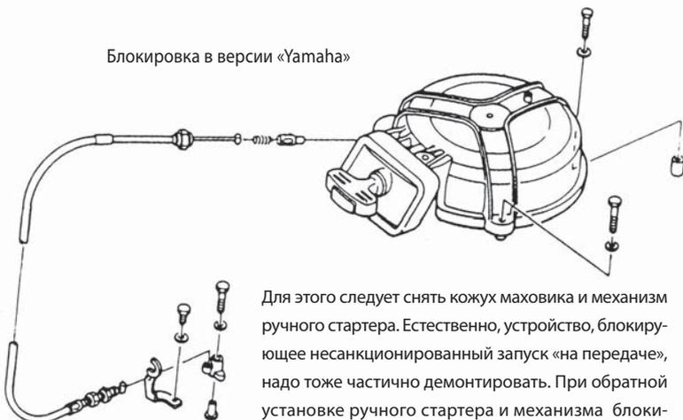
Для этого следует снять кожух маховика и механизм ручного стартера. Естественно, устройство, блокирующее несанкционированный запуск «на передаче», надо тоже частично демонтировать. При обратной установке ручного стартера и механизма блокировки надо все сделать правильно, т. е. установить все тяги или тросики на свои места и выполнить нуж-
