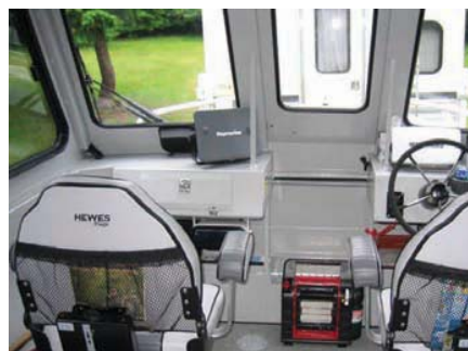
Керамический газовый обогреватель «Mr. Heater Buddy МН9ВХ» в салоне катера
