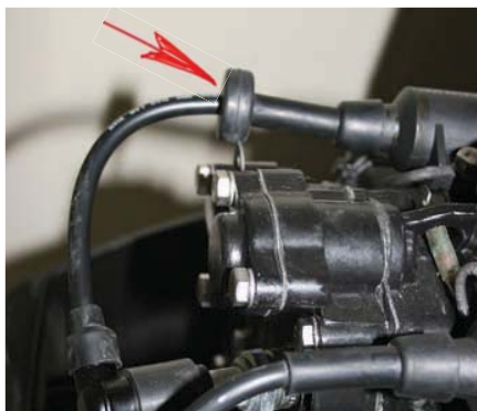
Для того, чтобы высоковольтный провод располагался подальше от металла «массы», применяют дистанционные резиновые шайбы
