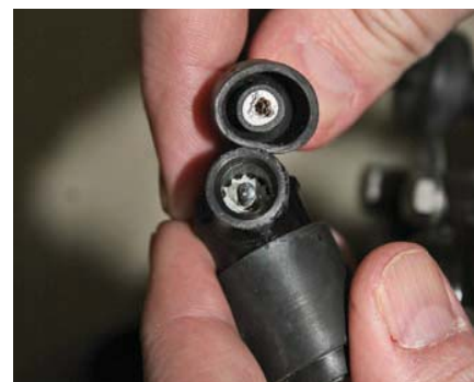
Распространенный способ подсоединения свечного колпачка — посредством резьбового центрального электрода («самореза»), на который навинчивается провод
