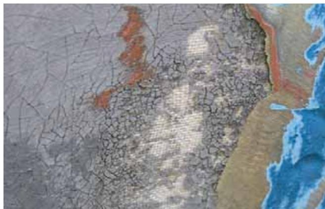
«Пожилый» стеклопластиковый корпус прошел грубую зачистку от прежних слоев краски, тем не менее класть грунт на такую поверхность еще рано: структура пластика нарушена, оголилась ткань, есть плохо держащиеся остатки старого грунта. Имеет смысл сначала провести дефектацию корпуса и обработать его жидкой эпоксидной пропиткой.
