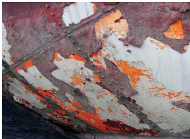
Хозяин этого стального бота следит за состоянием покрытия и заблаговременно усиливает его в районе переменной ватерлинии. Однако краска на днище невысокого качества и плохо держится на грунте после навигации.
