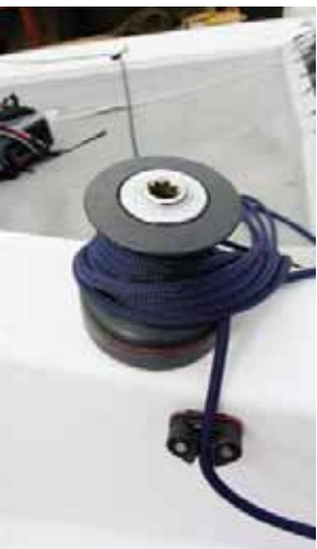
Стопора скричер-шкота: расположение неудобно
