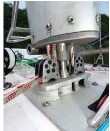
Поворотная мачта: мощный шарнирный степс
