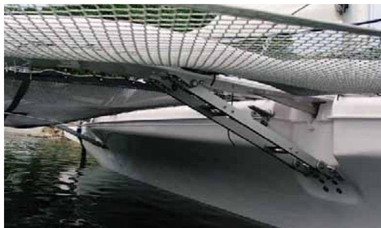
Механизм складывания поплавков: сделан очень жестко и надежно
