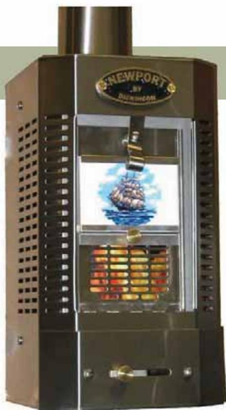
**Переборочная твердотопливная печь «Newport»** фирмы «Dickinson Marine Ltd.», Канада. Теплопроизводительность в зависимости от вида топлива — 1.5–2 кВт/ч. Смотровое окошко с регулируемой шторкой (70×110 мм), сменная футеровка топочной камеры, съемный зольный поддон. Материал — нерж. сталь. Габариты — 200×254×372 мм, масса — 5.5 кг. Цена — от 345 до 385 долл.
