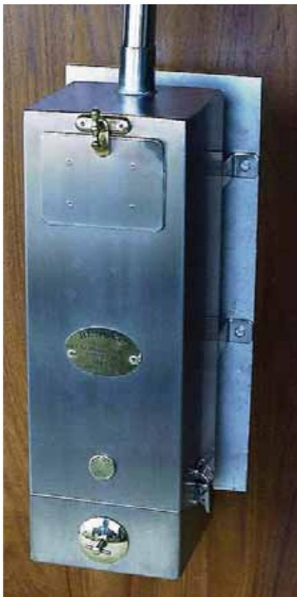
**Угольная печь «Bengco».** От переборки ее отделяет металлический экран из нержавеющей стали, под которым проложен слой из пробковой теплоизоляции. Между экраном и задней стенкой печи — 50-миллиметровый воздушный зазор. (Защитное ограждение отопителя на фото отсутствует). Габариты — 150×150×450 мм.
