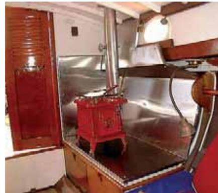
**Компактный одноконфорочный камелек-камбуз «Sardine»** фирмы «Navigator Stove Works LLC», США. Топливо: дрова, древесный уголь. Материал — чугун. На фото показано исполнение с покрытием красной керамоэмалью. Габариты — 30×30×28 см. Масса — 18 кг. Экранирование вокруг печи на фото — из нерж. стали. Дымоход диаметром 10 см.
