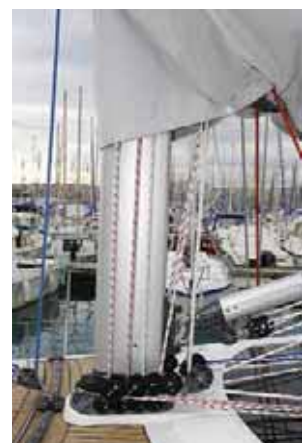
Степс мачты: установлен на палубе и исполнен вполне солидно
