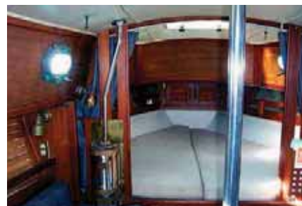
Рис. 2. Газовый отопитель «Cozy Cabin», установленный в главной каюте парусной яхты, размещен максимально низко — для улучшения тяги и прогрева нижней части каюты. Внизу корпус не сильно разогревается, так что с обивкой дивана ничего не случится, а вот дымоход становится очень горячим, поэтому неплохо было бы поставить защитный поручень или трубу большего диаметра вокруг дымохода, чтобы не обжечься.
