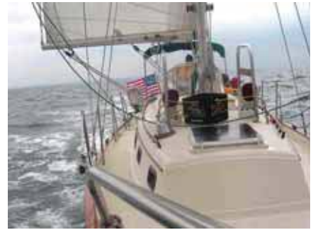
Рис. 7. По правому борту на крыше рубки виден коаксиальный дымоходный дефлектор отопителя «Dickinson Newport» с опциональным ограждением и ветро/брызгозащитным щитком
