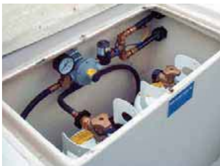
Рис. 9. Самодельный рундук на два газовых баллона. Корпус – из старого морозильного ларя.
