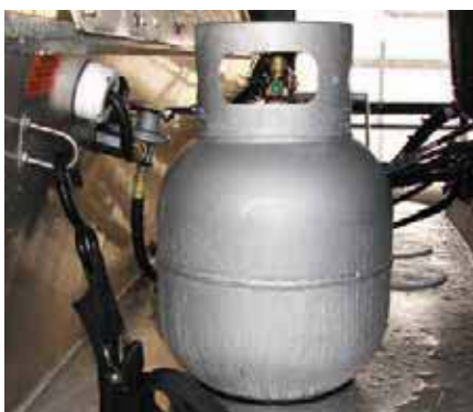
Рис. 10. Алюминиевый газовый баллон установлен на площадке для купания между основным транцем катера и вынесенным приварным транцем для двух подвесных моторов и крепится эластичным ремнем. На транце закреплен газовый редуктор и поставлен сальник газового шланга
