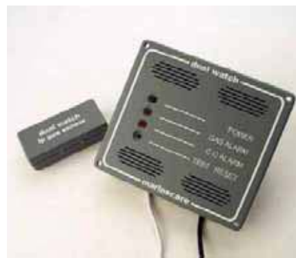
Рис. 12. Комбинированный газовый извещатель на пропан-бутан и СО. Питание — от бортовой 12-вольтовой сети, потребляемый ток — 120 мА. Фирма «Marine Care Ltd.», Великобритания. Габариты — 108×122×27 мм.
