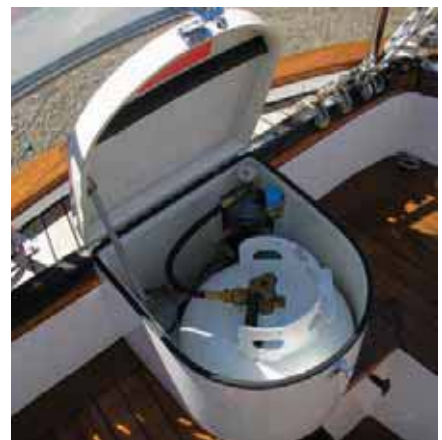
Рис. 8. Специальный рундук-контейнер для одного газового баллона системы газоснабжения, установленный в кокпите (фирма «Trident», США)
