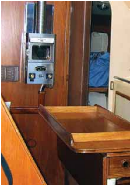
Рис. 4. Газовый переборочный отопитель «Dickinson Newport P12000» в интерьере каюты. Под столиком виден электрический тепловентилятор, который можно дополнительно включить во время стоянки у оборудованного электроснабжением причала. Теплопроизводительность: без вентилятора – 1,08–1,49 кВт/ч, с вентилятором – 2,16–3,1 кВт/ч. От 24-литрового баллона (10 кг) печка будет работать 78 ч на максимальном режиме и 110 ч – в экономичном. Габариты – 213×181×400 мм. Монтажная глубина – 200 мм. Масса – 9,1 кг.
