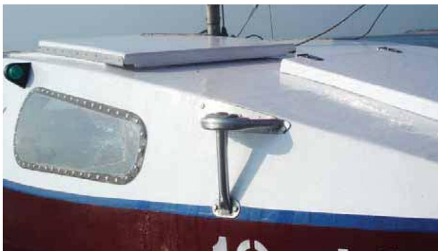
Под его сиденьями расположены два больших водонепроницаемых рундука для хранения вещей. Временно был поставлен руль навесного типа с подъемным пером, который ранее использовался на мотолодке «Прогресс» с парусом. Мачта самодельная длиной 4.5 м из титана, парусное вооружение имеет общую площадь 8 м<sup>2</sup>, грот взят от швертбота «Кадет», а стаксель пошит самостоятельно.
