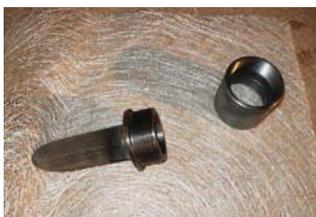
Дейдвудный стакан вклеивается в водовод при окончательной установке и центровке водомета
