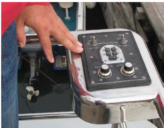
Значительная ширина судна требует размещения на обоих бортах таких мини-постов управления двигателями для маневрирования
