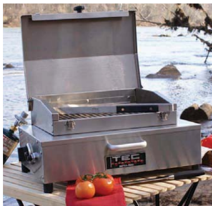
Портативный газовый инфракрасный гриль «ТЕС Cherokee FR». Тепловая мощность — 3400 ккал/ч. Площадь рабочей поверхности — 1240 см 2 . Корпус изготовлен из шлифованного алюминиевого сплава, решетка — из нержавеющей стали AISI 304. Крышка снабжена двумя защелками. Габариты — 60×40×27 см, вес — 16 кг.
