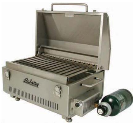
**Инфракрасный судовой газовый гриль «Solaire Anywhere» (SOL-IR17M).** Показан с одноразовым пропановым баллоном. Тепловая мощность горелок — 3400 ккал/ч. Рабочая решетка — из V-образных ламелей. Электро-розжиг от батарейки. Крышка снабжена двумя защелками и фиксатором в открытом положении. Регулируемые по высоте ножки для использования на природе или на столе. Площадь рабочей поверхности — 1000 см<sup>2</sup>. Габариты — 53×33×30 см, вес — 9 кг.
