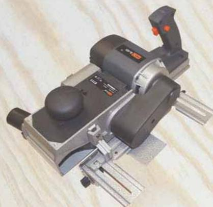
Скорость вращения барабана, на который крепятся ножи, тоже имеет значение для многих работ. Чем она выше, тем чище получается обработанная деталь и тем быстрее можно совершить «проход» рубанком по поверхности.
