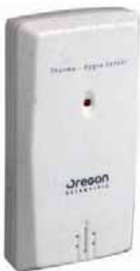
Выносной датчик температуры и влажности станции «Oregon» желательно устанавливать в тени или прикрывать его свободно пропускающим воздух, но отражающим прямые солнечные лучи экраном
