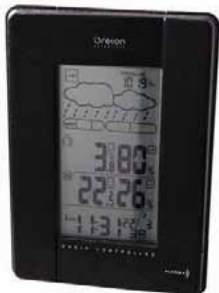
Довольно простая «домашняя» станция «Oregon» китайского производства, показывающая давление, а также температуру и влажность дома и на улице. Кстати, подобно большинству зарубежных устройств, давление здесь указывается либо в миллибарах, либо в дюймах ртутного столба, в отличие от привычных нам миллиметров – нужна переводная таблица, которую можно найти в Интернете и распечатать. Часы устанавливаются по радио – как утверждает инструкция, по сигналу, передающемуся откуда-то из Англии.
