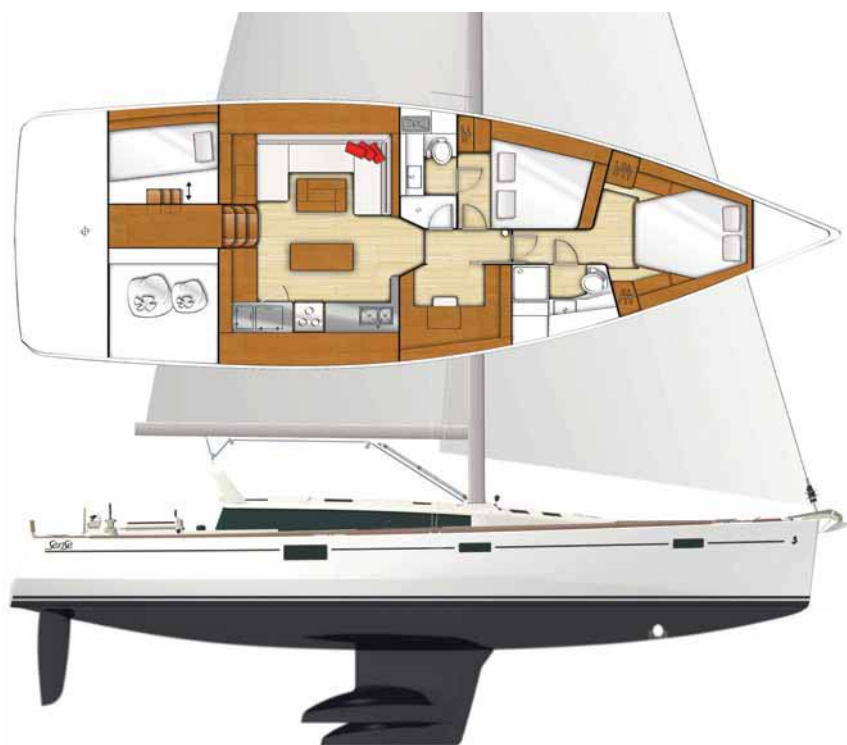
Общий вид и план подпалубных помещений («Sense 50»)
