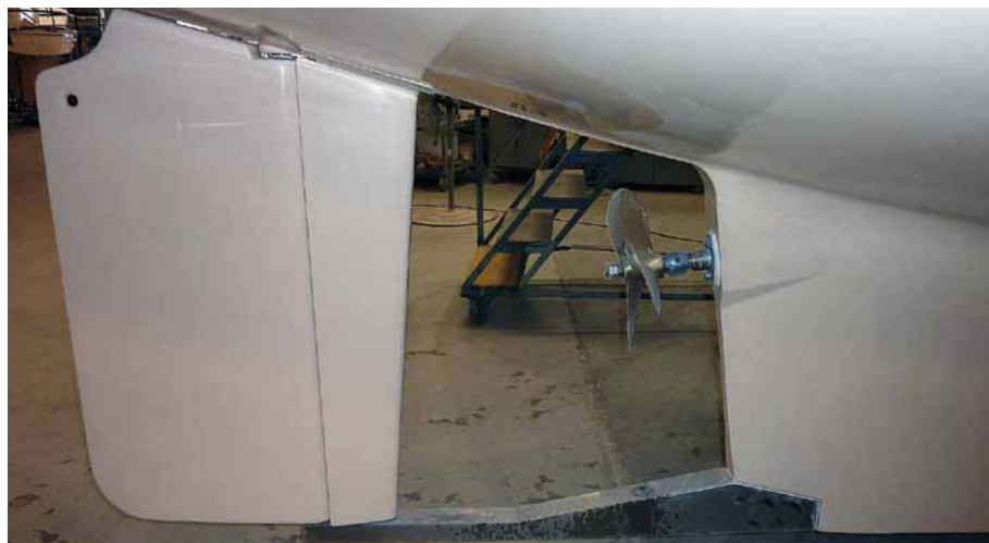
Длинный киль хорошо защищает винт и руль
