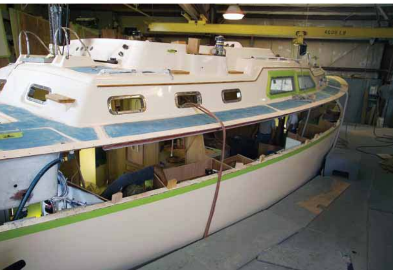
Соединение секций корпуса и палубы
