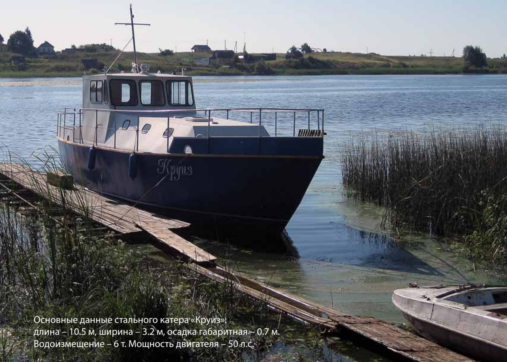
Основные данные стального катера «Круиз»: длина – 10,5 м, ширина – 3,2 м, осадка габаритная – 0,7 м. Водоизмещение – 6 т. Мощность двигателя – 50 л.с.
