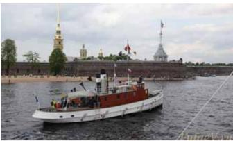
нальный двигатель 1893 г. Паровую машину реконструировали в 1925-м, она работает на низких оборотах, около 90 в минуту, развивая скорость до 10 уз (около 18 км/ч).
