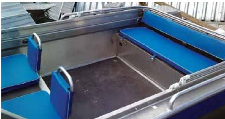
вой раме, снабженным откидной центральной «форточкой» для прохода в кокпит с носа и большими треугольными бортовыми секциями. Передним и задним сиденьями служат два объемистых алюминиевых рундука с мягкими подушками (спинки переднего сиденья – съемные, на
