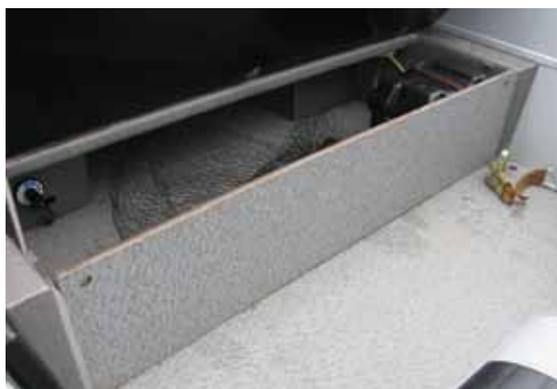
Кормовой рундук ужат до минимума, и для размещения багажа его передняя стенка сделана съемной
