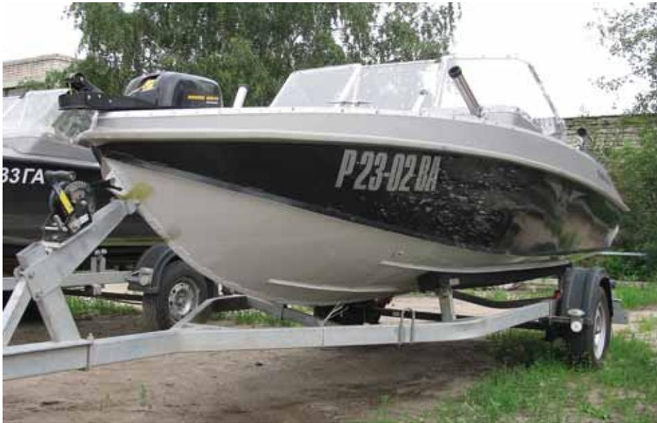
Вот то, что кокпит лодки не имеет самоотлива и отправляет воду в трюм под автоматическую помпу, заметно снижает «надежность» владения лодкой. Дожливой недели хватит, чтобы залить не защищенную предусмотрительно тентом лодку до пайолов, а аккумулятор помпы имеет свойство разряжаться. Покупатель должен быть готов к борьбе со стихией. Впрочем, всякое конструкторское решение чем-либо обосновано, вот и низко расположенный пайол доказал свою полезность.
