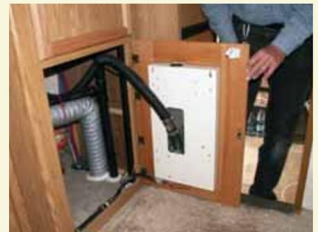
Дверцу укрепили дополнительными петлями, чтобы она могла выдержать вес обогревателя. Небольшая, но важная деталь: в правом верхнем углу имеется предохранительная защелка, удерживающая дверцу с обогревателем во время движения кемпера.
