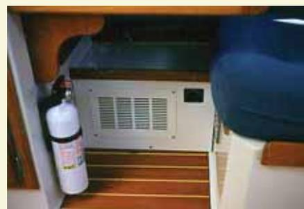
**Обогреватель серии «5H»** американской фирмы «HeaterCraft», установленный на парусно-моторной яхте «Catalina 34» под штурманским столиком в специально изготовленном для этой цели корпусе. Сверху корпус накрыт декоративной тиковой столешницей. Рециркуляционный воздух поступает в печку сверху через воздушный зазор в задней части корпуса. Размер выпускной решетки – 287×190 мм.
