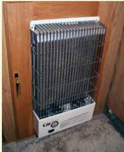
**Вентилируемый каталитический обогреватель «Platinum CAT», модель «BP12», установленный в мебельной дверце салона автокемпера.** Теплопроизводительность – 1,3 кВт (5.200 БТЕ/ч). Расход пропана – 115 г/ч. Потребление энергии (12 В) – не более 0,5 А (первые 2 мин. – 5 А). Наружный диаметр гибкого дымоотвода – 38 мм. Соединение по газу – развальцованное, 3/8 дюйма (9,53 мм). Габариты – 305×137×534 мм.
