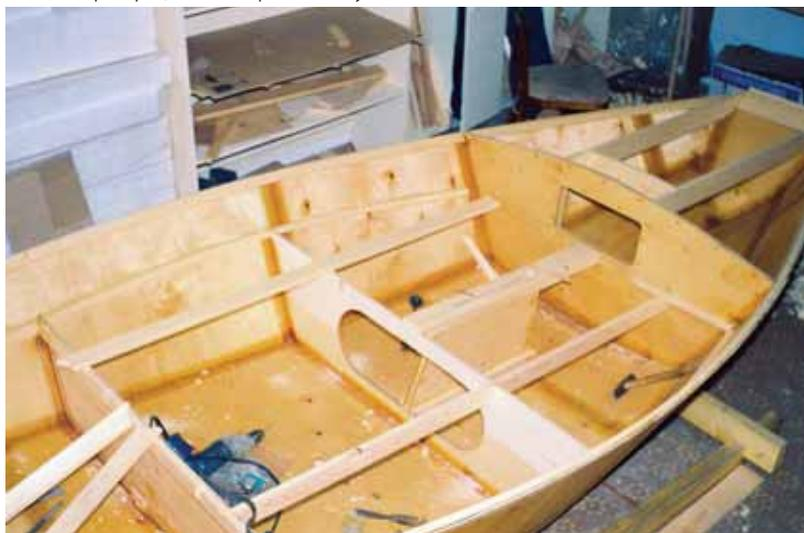
носителю широкий, плоскодонный в районе миделя, корпус с хорошим развалом бортов по всей длине позволяет спокойно принимать шквалы. На такой лодке рулевой даже в свежий ветер чувствует себя уверенно. Швертбот сохраняет способность лавироваться и под одним гротом. В случае оверкиля швертбот легко можно вернуть в нормальное положение, а для непотопляемости в корпусе установлены пенопластовые блоки плавучести.
