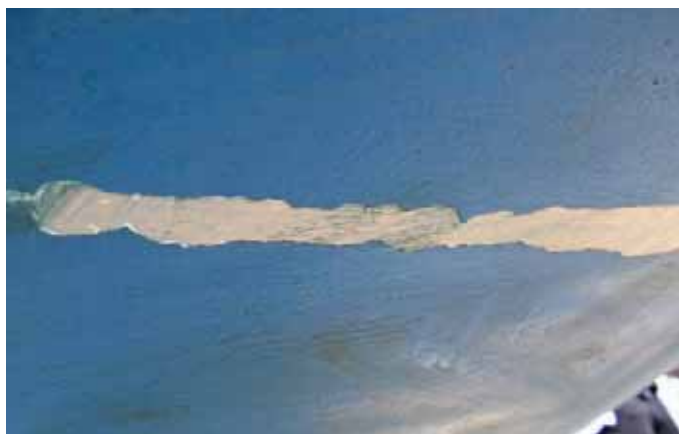
Поверхность под твердую «необрастайку» необходимо тщательно подготовить. Посадка на камни не испортила первичного эпоксидного грунта, но слой краски сошел вместе с виниловой подложкой
