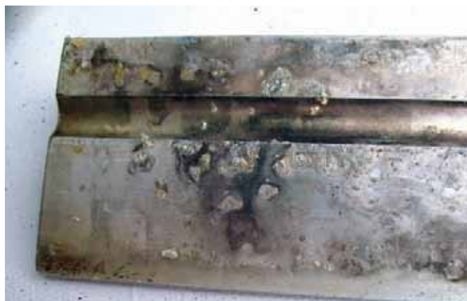
Алюминиевый интерцептор не вынес контакта с медесодержащей краской – точки гидроокиси и «поеденная» поверхность свидетельствуют о развившейся за лето коррозии
