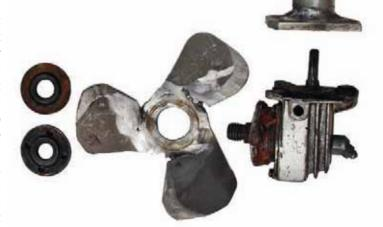
вратить обратно в бензокосу: для этого достаточно снять с верхней штанги косы наш фланец с отрезком трубы и надеть нижнюю штангу с редуктором триммера.
