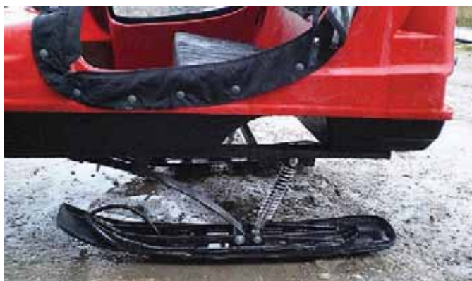
Оригинальная подвеска саней разработана инженером компании «7 футов» и приспособлена для российских условий
