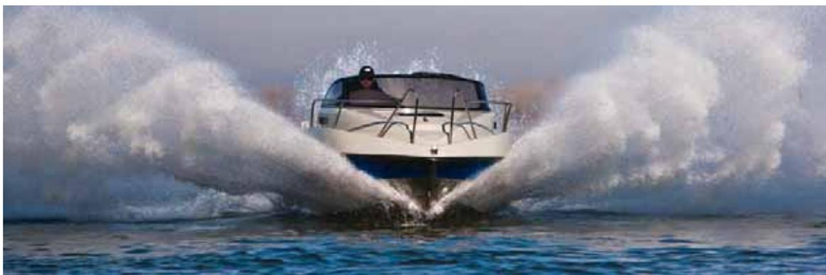
*«Торможение» реверсом без сброса газа занимает ровно 4 с (время срабатывания актуатора заслонки от упора до упора). Вначале лодка ощутимо клюет носом, поскольку пару секунд заслонка отбрасывает поток строго вниз, приподнимая корму*
