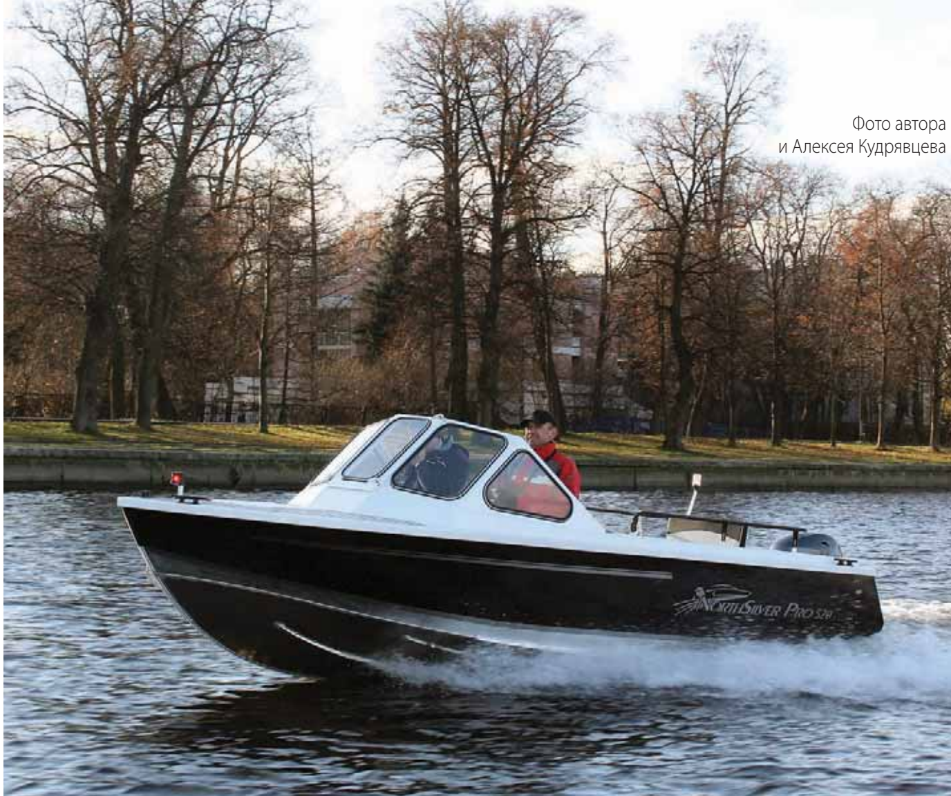
Лодка идет «налегке». Отсутствие лишних замыслов и правильный дифферент в четыре градуса указывают на оптимальное сочетание основных характеристик для крейсерской скорости
