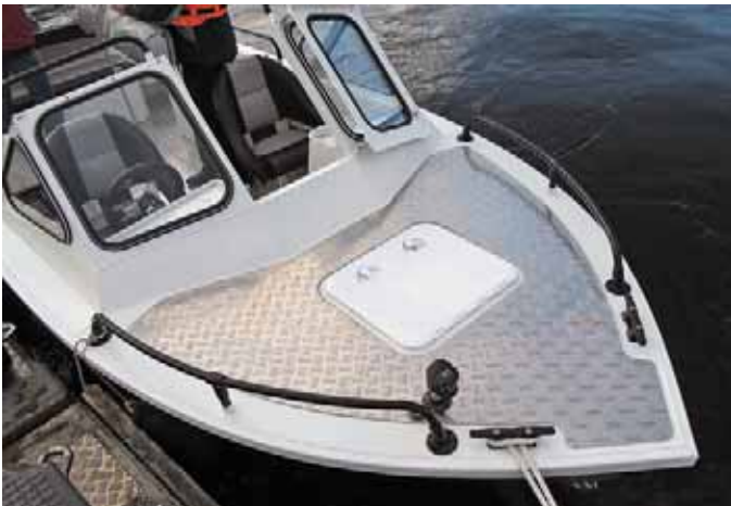
Рифленый настил, леер по борту, прочная «калитка» в ветровом стекле – все, что нужно для безопасного выхода на нос
