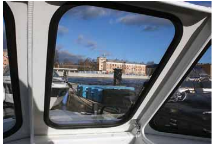
Проход в стекле плотно закрывается «патефонным» замком
