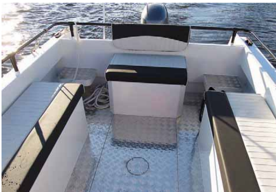
В просторном кокпите предусмотрены рундуки для багажа, надежное леерное ограждение и очень удобные ступеньки перед рецессом
