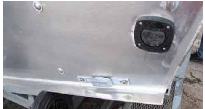
Малозаметные, но полезные детали на транце: сливной шпигат большого диаметра прикрыт резиновым клапаном; магниевый протектор защищает корпус от соседства с «нержавейкой» мотора
