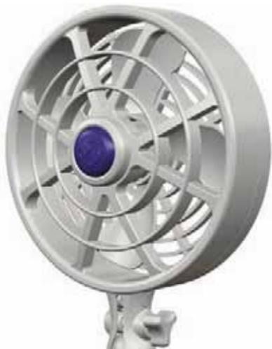
Одноростной персональный вентилятор «Saframo Satapo 743». Диаметр крыльчатки – 127 мм. Производительность – 270 м<sup>3</sup>/ч, потребляемый ток – 0,4 А. Выключатель расположен на ступице крыльчатки. Защитные решетки на всасывании и нагнетании. Используемые материалы – пластик ABS и нержавеющая сталь. Ресурс двигателя – 2000 ч. Габариты – 152×64×216 мм
