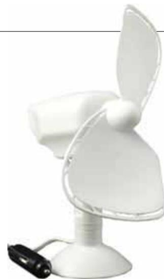
Двухскоростной вентилятор «Caframo Ultimate 747». Выключатель/переключатель скоростей расположен на тыльной части корпуса двигателя. Показан со съемной присоской, позволяющей устанавливать вентилятор на любой подходящей гладкой плоскости. Подпружиненная поворотная опора (закрепляемая стационарно) позволяет направлять воздушный поток в нужном направлении. Габариты – 180×140×230 мм
