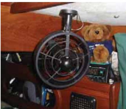
«Hella Jet» – компактный односкоростной вентилятор, который можно складывать в плоскость переборки. Производительность – 144 м<sup>3</sup>/ч, потребление энергии – 3,5 Вт/ 0,29 А. Диаметр крыльчатки – 130 мм, диаметр решетки – 155 мм, макс. глубина – 80 мм, длина с поворотной опорой – 205 мм. Возможность монтажа и фиксации в любом положении. Выключателем служит декоративная крышка на ступице крыльчатки
