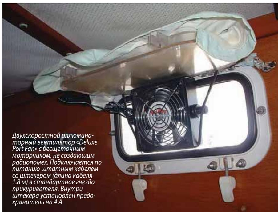
Двухскоростной иллюминационный вентилятор «Deluxe Port Fan» с бесщеточным моторчиком, не создающим радиопомех. Подключается по питанию штатным кабелем со штекером (длина кабеля 1,8 м) в стандартное гнездо прикуривателя. Внутри штекера установлен предохранитель на 4 А
