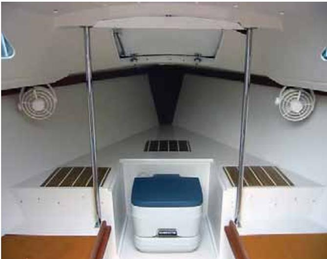
Два вентилятора «Hella Turbo», установленные над койками в «кадди» 6-метровой яхты «Capri 18»
