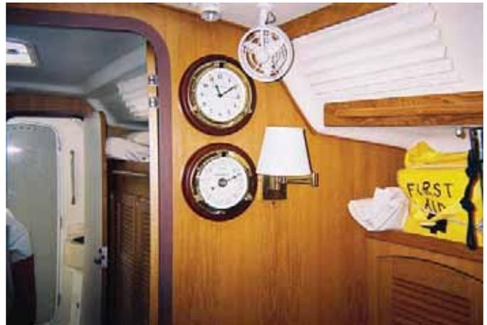
Вентилятор «Hella Jet», установленный в углу салона рядом с откидным иллюминатором (закрит шторкой-гармошкой). При открытом иллюминаторе поток от вентилятора способствует поступлению в каюту свежего воздуха. Питание подведено от кабеля светильника. Показан в сложенном, нерабочем положении
