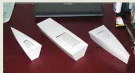
ции которой укладывались бы одна в другую. Среди существенных особенностей конструкции – отсутствие набора. К элементам набора можно отнести, пожалуй, только торцевые стенки секций, играющие роль шпангоутов (2 шт. на 6 м длины); формообразование корпуса и его жесткость обеспечивались погибью деталей обшивки.
