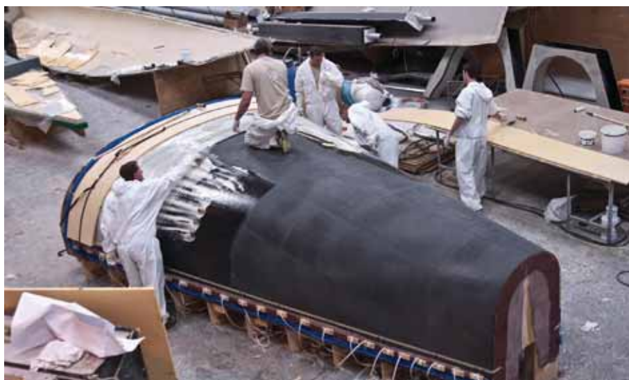
Специалисты Salthouse Boatbuilders формируют новую носовую часть для корпуса яхты Team Sanya. Фото Marc Bow/Volvo Ocean Race
