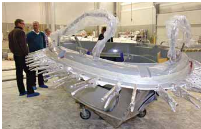
Секции склеиваются герметиком с помощью дедовских струбцин
