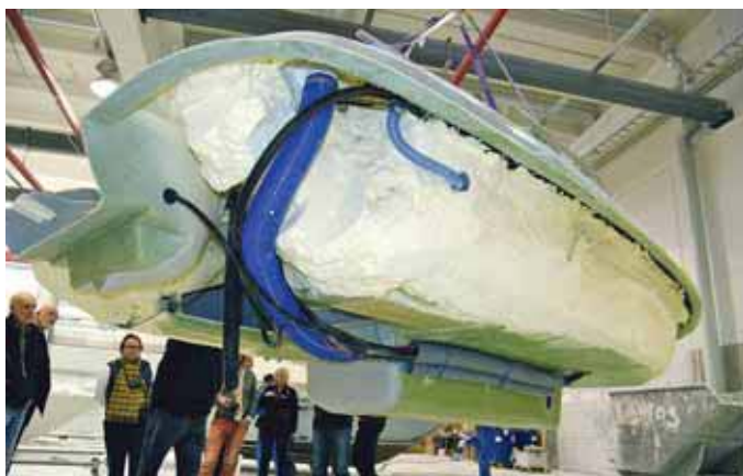
Палубный «пластик» обвешен блоками аварийной плавучести и шлангами скрытой электропроводки
