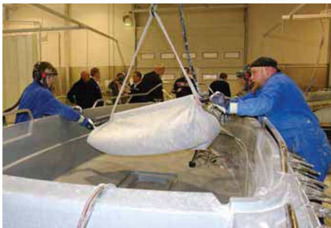
Для надежности склейки – палубу прижимают гнетом
