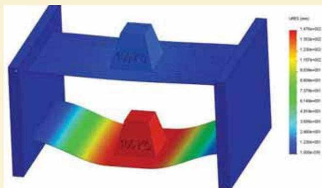
скручиваниям (разница в жесткости листа с реданами и без реданов показана на рисунке). «Квинтрекс Рус» обладает собственными прессами, которые позволяют производить реданы различной длины и формы.
