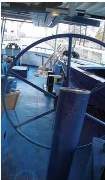
Этот резервный штурвал, дополненный аксиометром, имеет чисто механический цепной привод (отсюда и размеры) и может использоваться в случае отказа сервопривода основного рулевого управления, хотя управлять судном по курсу можно и машинами
