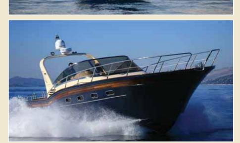
Основные данные яхты (стандартная комплектация): длина –12.0 м, ширина – 4.0 м, осадка –1.05 м; водоизмещение – 9500 кг; мощность – 2×260 л.с.; макс. скорость – 25 уз
