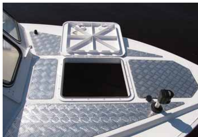
Та же «рифленка» наклеена на носовую палубу. Осторожно: не запнитесь о съемный огонь
