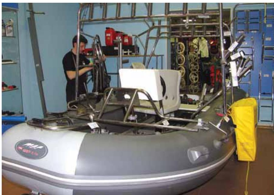
комплектации заводов-изготовителей. Ноу-хау «Техномарина» начинается с модульности представленного оборудования, разнообразия вариантов крепежных фитингов, с которыми металлоконструкции можно «привязывать» к лодкам, самым разнообразным по размерениям и материалу корпуса. Есть специальные фитинги для фанерных пайолов, для надувных днищ высокого и низкого давления, для баллонов, а также трубчатых конструкций – больших и малых диаметров. Это значит, что начав «вооружать» судно
