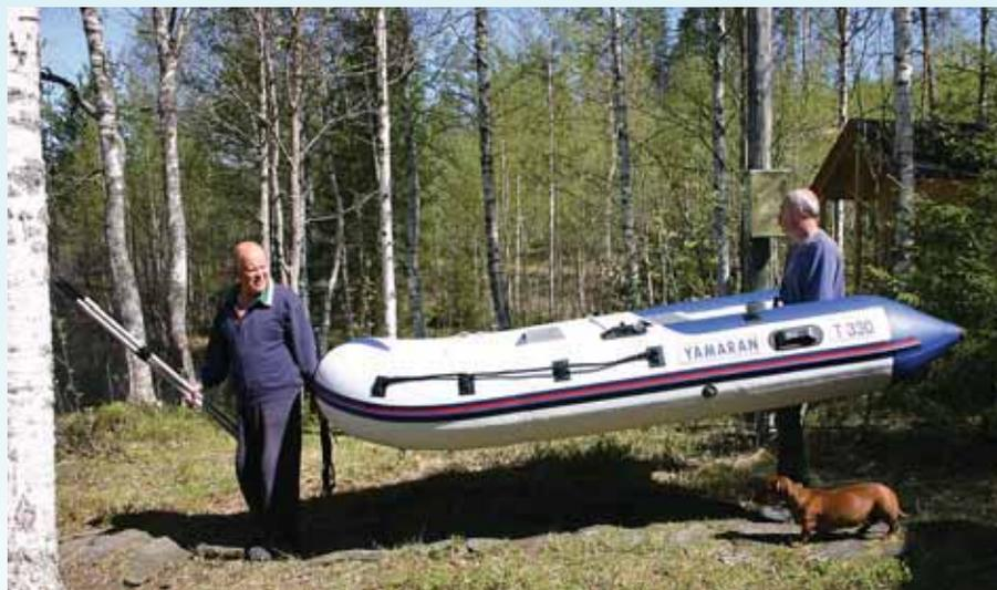
метра баллона (47 см) и гарантированно работающего при ветре и волне привального бруса. Эта лодка проходит по категории С (прибрежное плавание), то есть позволяет чувствовать себя в безопасности на волне до 2 м и ветре до 13.8 м/с (6 баллов по шкале Бофорта). Хотя в море ситуации бывают и похлеще.
