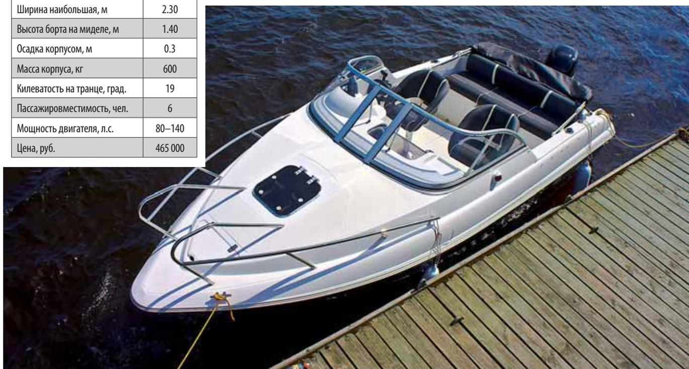
буйте установки стеклоочистителя, а в дождь для улучшения обзора с водительского места рассчитывайте на подручные средства. Хорош носовой релинг: жесткий, эргономичный, аккуратно сваренный. Нержавеющий бак в 160 л объемом, напротив, сварен «так себе», даром что не бросается в глаза в своем трюме.
