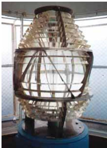
Первый светооптический аппарат маяка. На фото справа – современный аппарат
