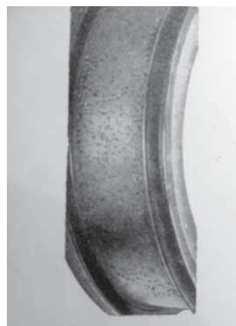
Рис. 3. «Пористость» на дорожке качения кольца роликоподшипника вследствие недостаточной твердости (взято из книги: Бейзельман Р. Д., Цыпкин Б. В. Подшипники качения. М., 1959)
