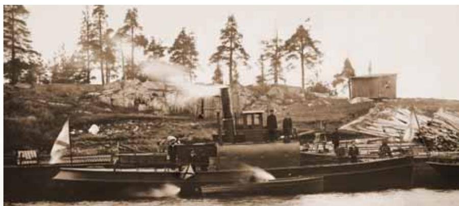
*Буксирный пароход «Вячеслав» (б. «Неси-Арви»), 1916. Буксировал по 5 барж грузоподъемностью по 60 т. У борта стоит моторный катер «Быстрый»*
