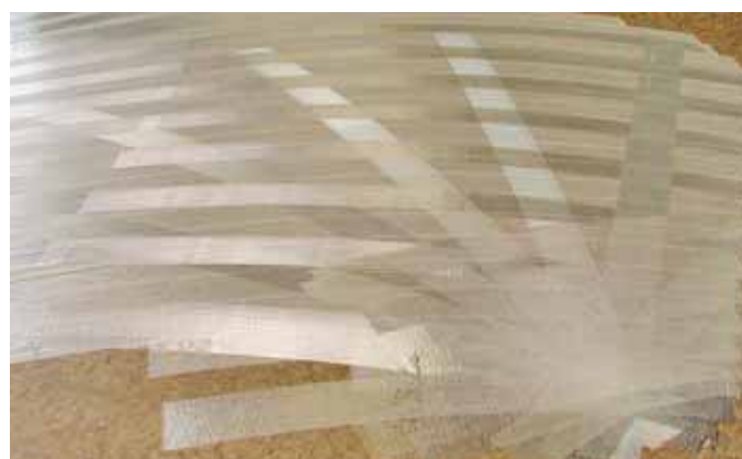
Нанесение лент при изготовлении паруса по технологии 3Di
