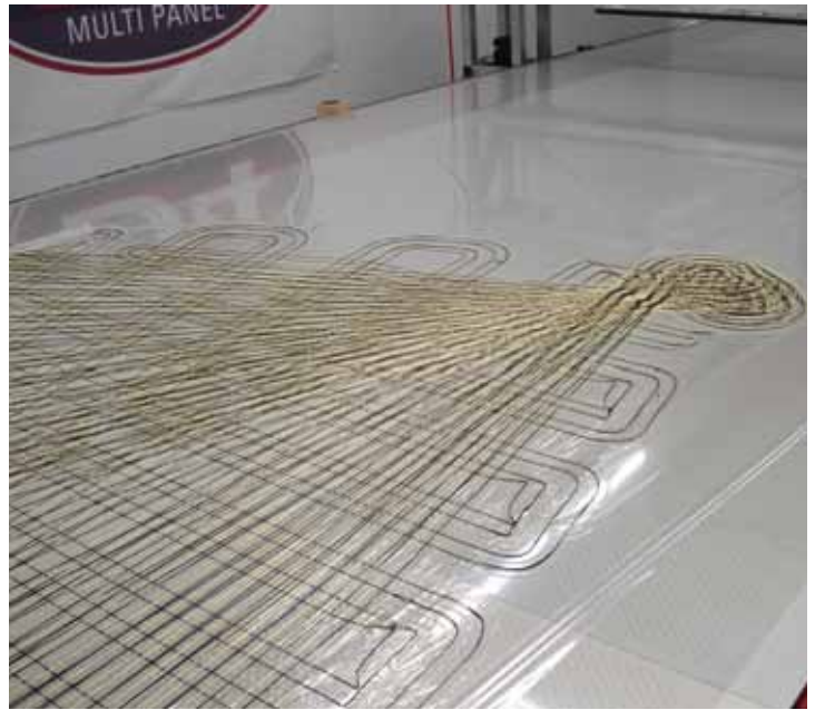
Формирование «мембраны» угла паруса по технологии D4
