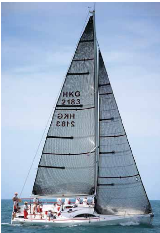
Яхта с парусами, изготовленными по технологии Tape-Drive
