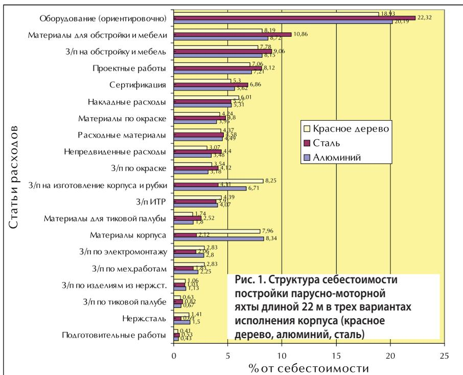
Рис. 1. Структура себестоимости постройки парусно-моторной яхты длиной 22 м в трех вариантах исполнения корпуса (красное дерево, алюминий, сталь)
